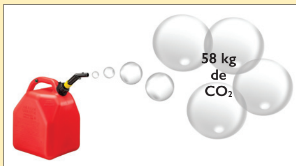
Illustration 8 : La combustion de 20 litres (14,5 kg) d'essence entraîne l'émission de 58 kg de CO 2 . Comme le CO 2 est un gaz et non un liquide, il occupe un volume beaucoup plus large, bien plus grand que l'illustration.
